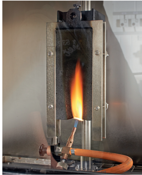
DIN EN 13501-1 class E: single-flame source test
