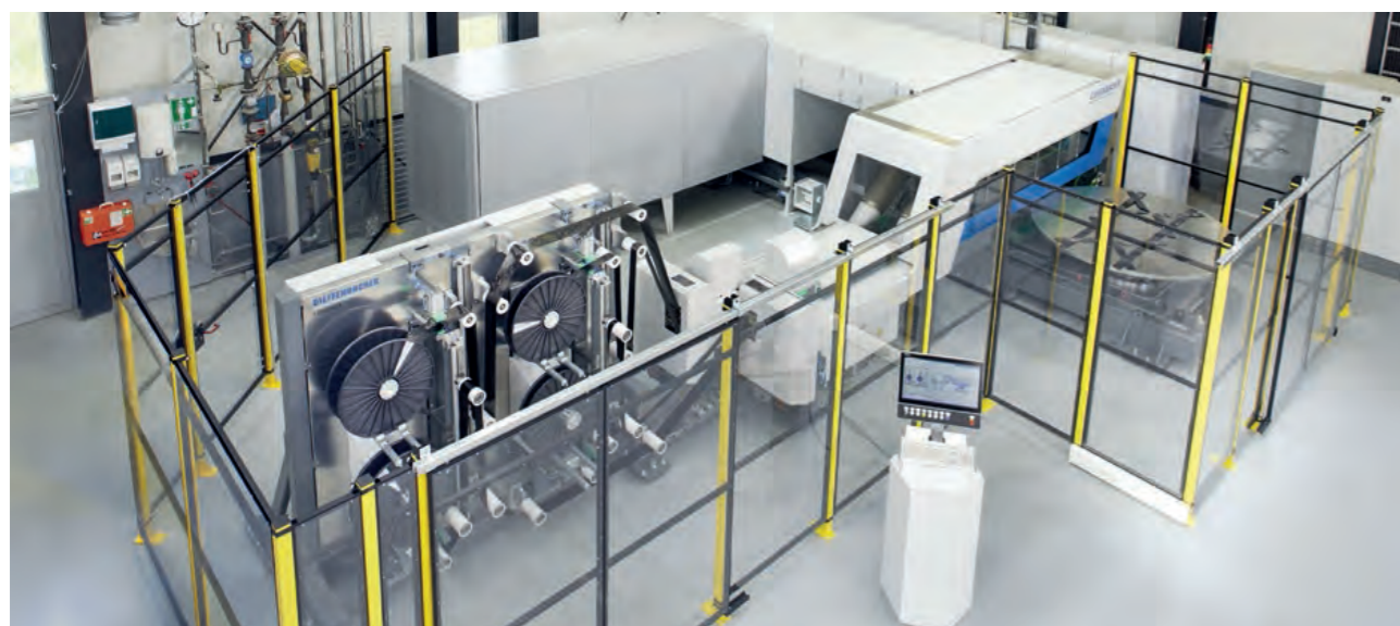
3.1 FIBERFORGE-TAPELEGER ALS BESTANDTEIL DER REFERENZ-PRODUKTIONSANLAGE AM FRAUNHOFER ICT
