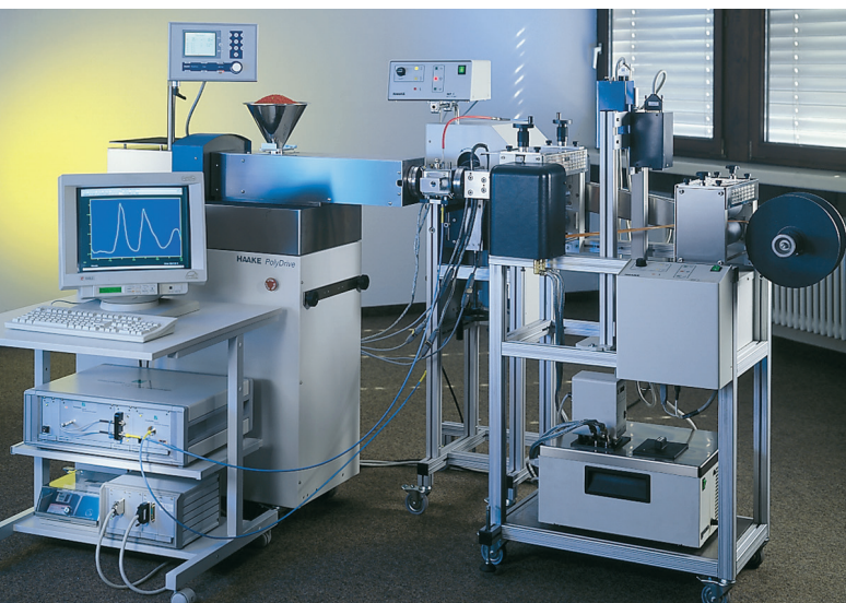
Doppelschneckenextruder mit Nahinfrarotspektrometer.
