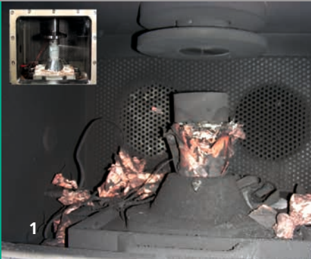
1 Deformationstest an einer hochgeladenen (100 % SOC) Li-Ionen-Zelle in Schutzumgebung.
