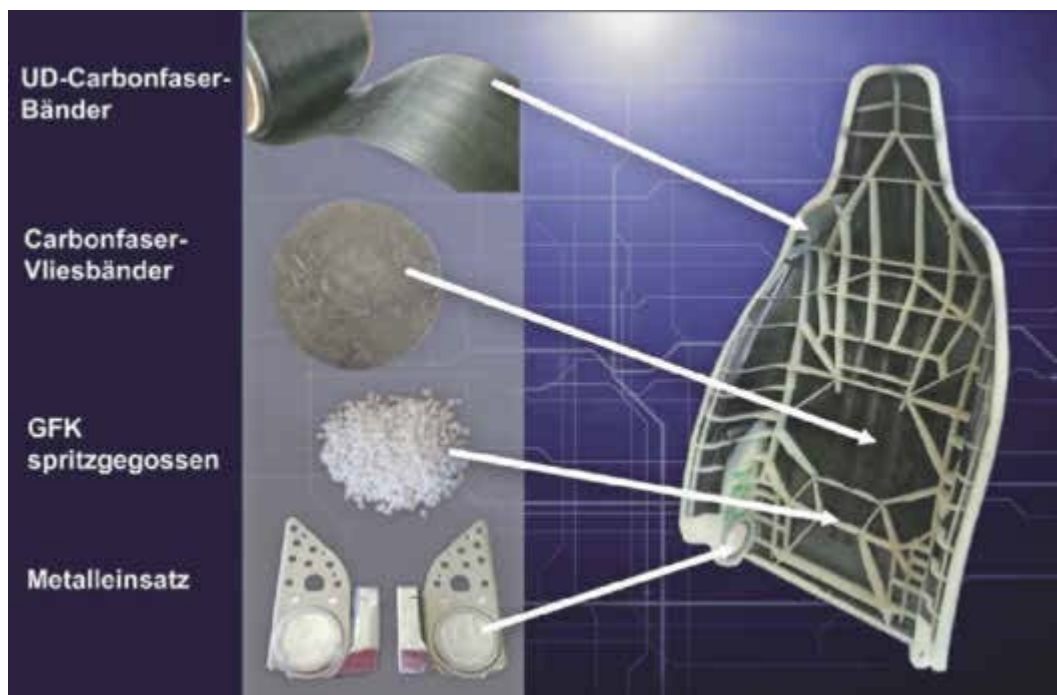
Diese Projektskizze aus Camisma verdeutlicht den Aufbau der hybriden Leichtbau-Sitzlehne. Daneben sind die Metalleinsätze von ARaymond zu sehen, die nach dem Fertigungskonzept von MoPaHyb als Einleger direkt integriert werden. Bilder: JCI/Adient; ARaymond
