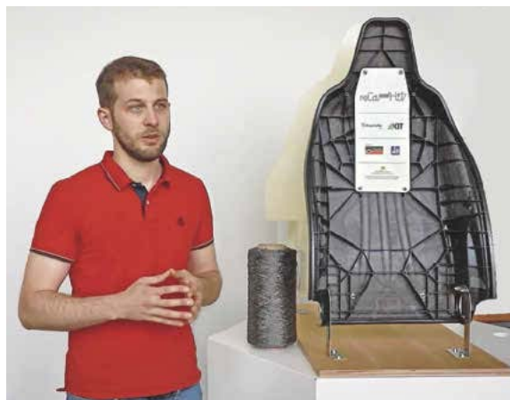
Es gibt noch weitere Sitzlehnen-Projekte. ICT-Forscher Sascha Kilian zeigt einen Demonstrator mit recycelten Carbonfasern, entwickelt in ReCaHit. Bild: Fraunhofer ICT
