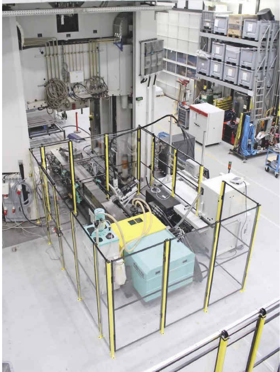
Blick von oben: Das Foto zeigt, wie eine Arburg-Spritzeinheit in die große Dieffenbacher-Pressen eingeführt wird. Bild: Arburg
